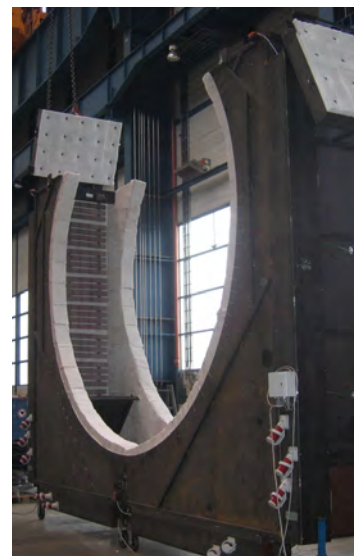
Kétrészes előmelegítési berendezés forgó nagy tartályokhoz
