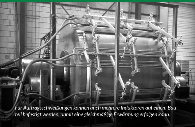
*Für Auftragsschweißungen können auch mehrere Induktoren auf einem Bauteil befestigt werden, damit eine gleichmäßige Erwärmung erfolgen kann.*
