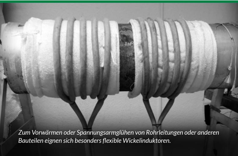
Zum Vorwärmen oder Spannungsarmglühen von Rohrleitungen oder anderen Bauteilen eignen sich besonders flexible Wickelinduktoren.
