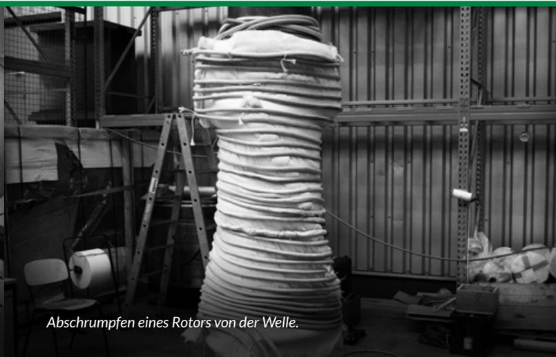
Abschrumpfen eines Rotors von der Welle.
