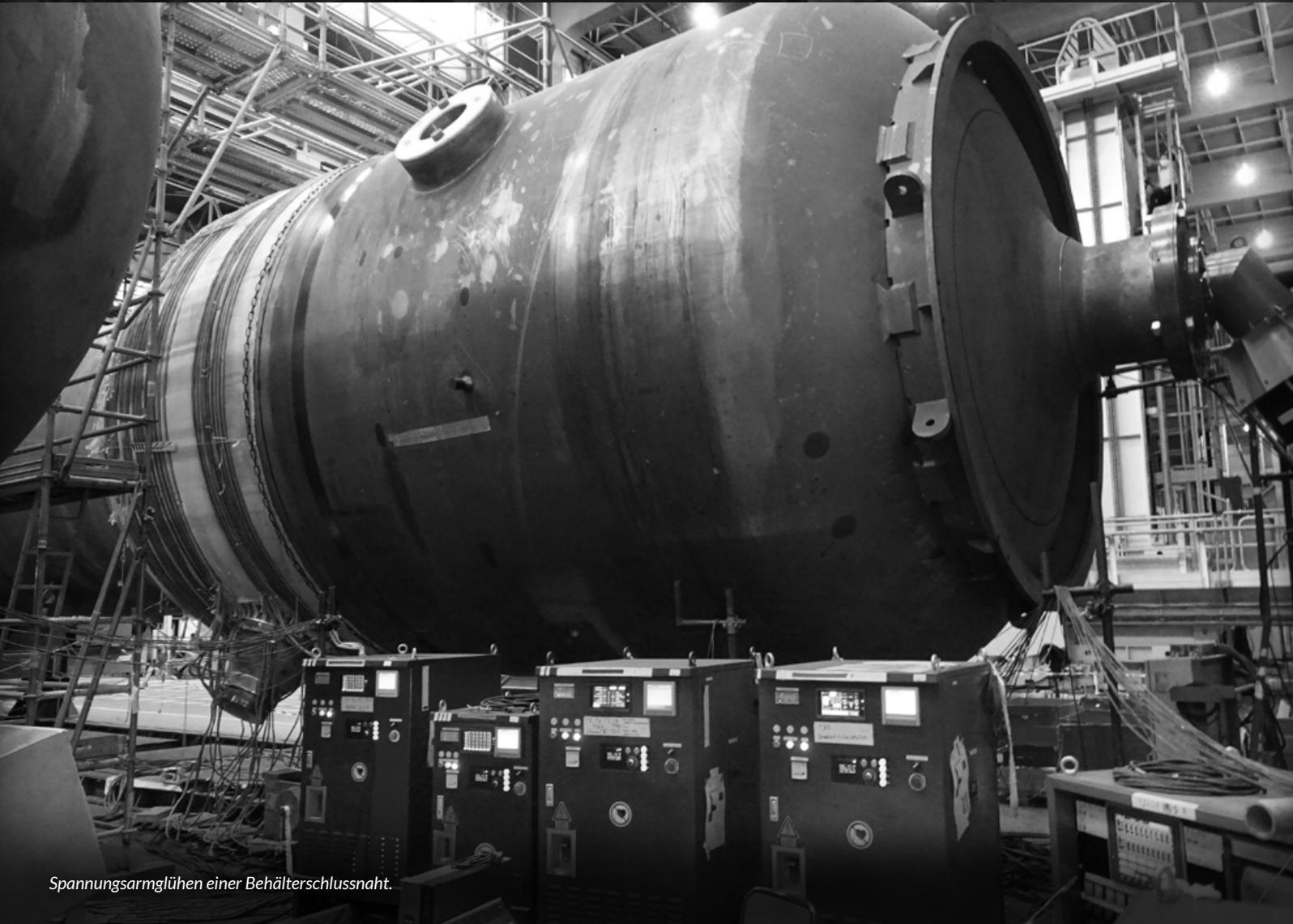
*Spannungsarmglühen einer Behälterschlussnaht.*
