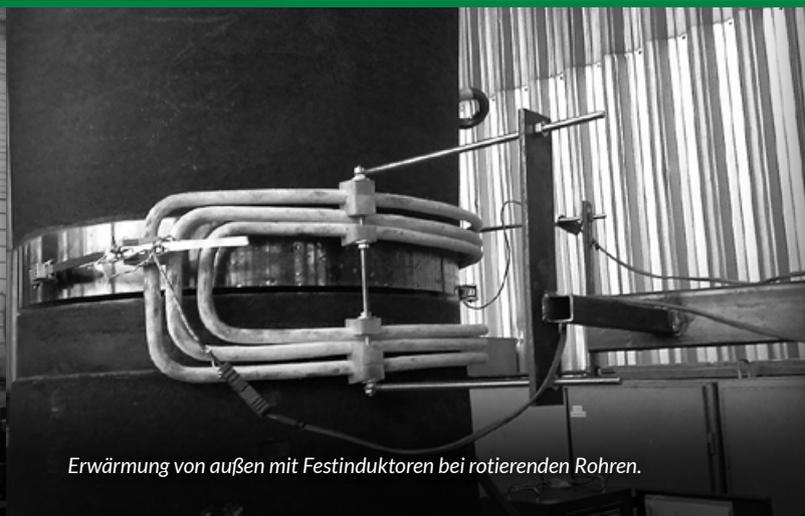
*Erwärmung von außen mit Festinduktoren bei rotierenden Rohren.*
