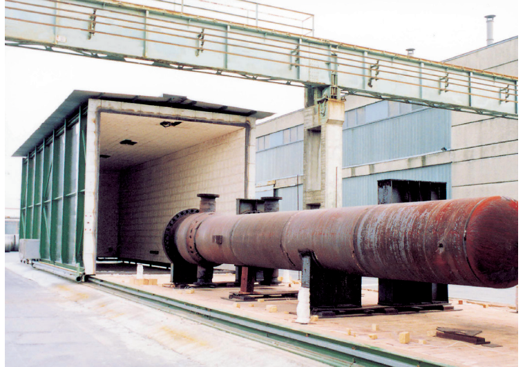
Büyük kaplarda gerilim giderme işlemi için Gazlı Tavlama Fırını Açık genişlik: 6000 mm Açık yükseklik: 6000 mm Açık uzunluk: 16000 mm
