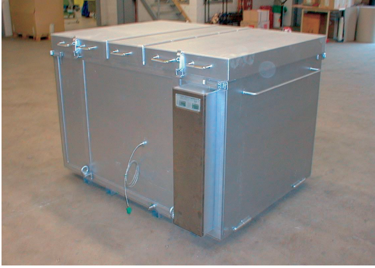
Takımlar ve dövme kalıplarının ön ısıtma ve gerilim giderme işlemleri için Ön Isıtma ve Tavlama kutuları
