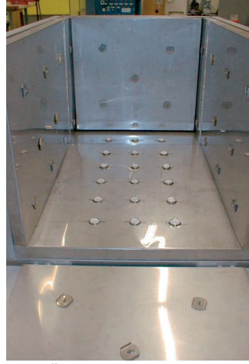
Takımlar ve dövme kalıplarının ön ısıtma ve gerilim giderme işlemleri için Ön Isıtma ve Tavlama kutuları
