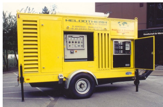
Автономная нагревательная установка с дизельным генератором на автомобильном шасси.
