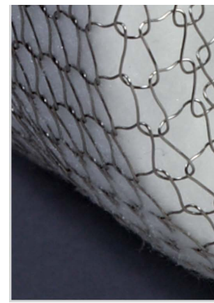
Мат из керамического волокна в проволоочной сетке
