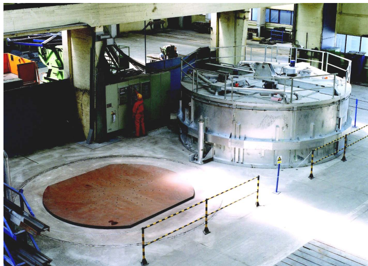
Цилиндрическая колпаковая печь с электрическим нагревом
