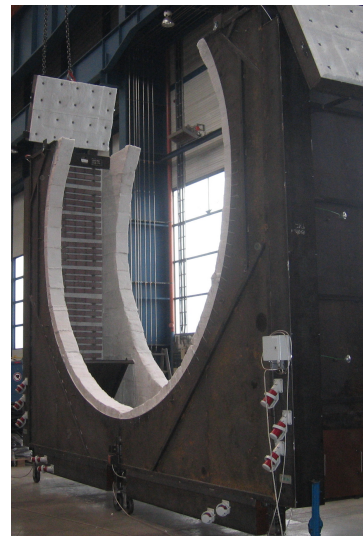
2-х секционная конструкция для проведения термообработки ёмкости с рольганга
