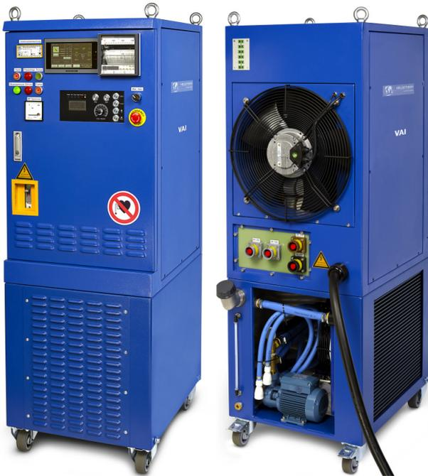
Induktions- Glühanlagen der VAI- Serie eignen sich hervorragend um metallische Bauteile wie z.B. Rohrleitungen oder Schweißnähte innerhalb kürzester Zeit zu erwärmen.
