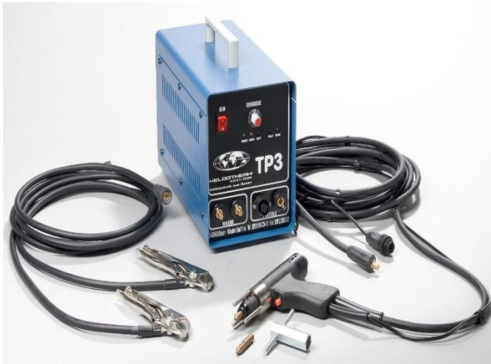
Tragbares Bolzenschweißgerät in Kathodenschutz Ausführung mit Spitzenzündung. Ideal zum blitzschnellen Befestigen von Isoliernägeln und Bolzen. Durch den Mikroprozessor gesteuerten Schweißablauf entstehen auch bei dünnen, lackierten oder beschichteten Blechen keine Markierungen auf der Sichtseite. Eingebauter Kühlluftventilator.
